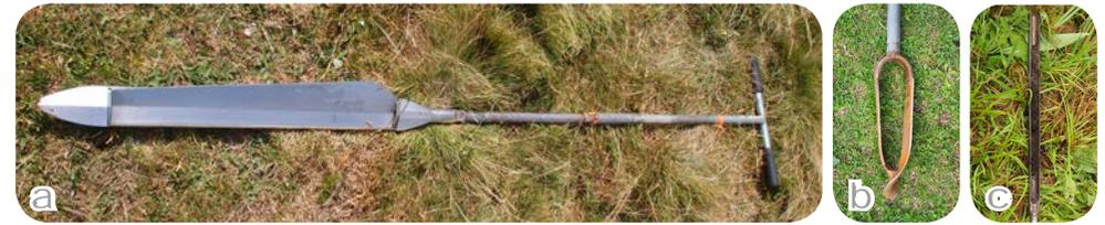
Figure II-5-1: le carottier russe (a), la tarière Edelman (b), la tarière gouge (c).
