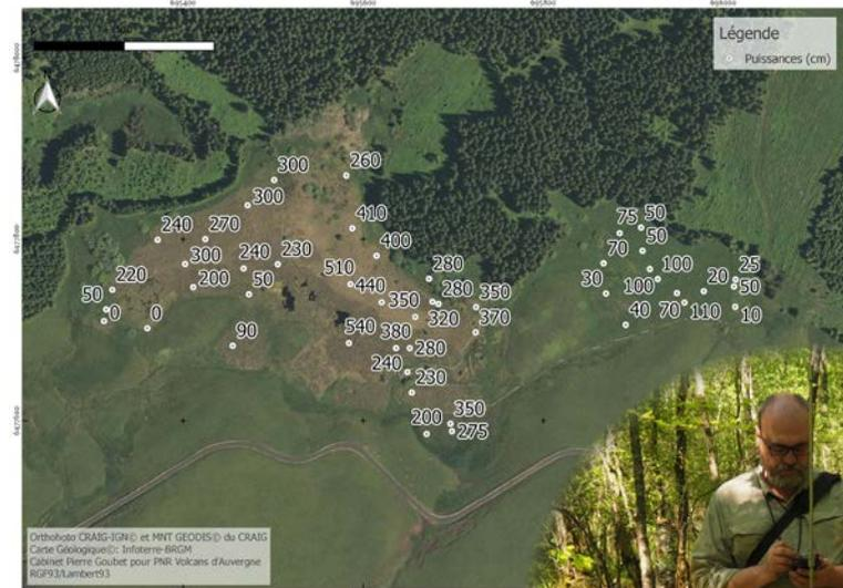
Figure II-4-1: évaluation des épaisseurs de tourbe à la perche métallique.
